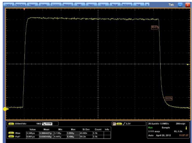
PCM-7510, 50 A, 150 \mu s pulsewidth
