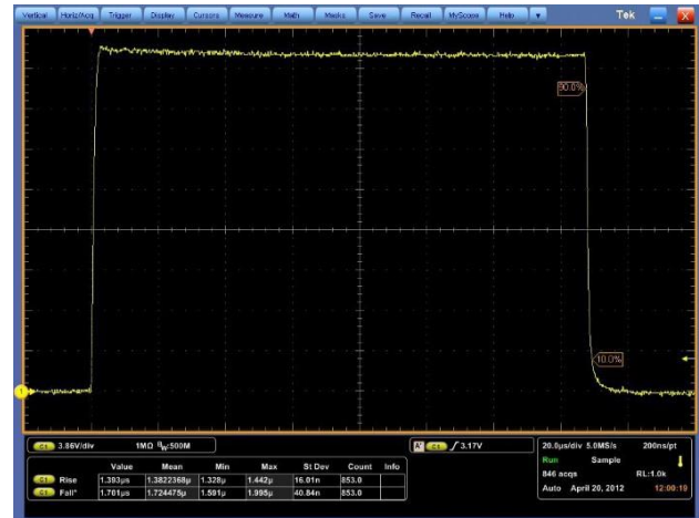
PCM-7510, 250 A, 150 \mu s pulsewidth
